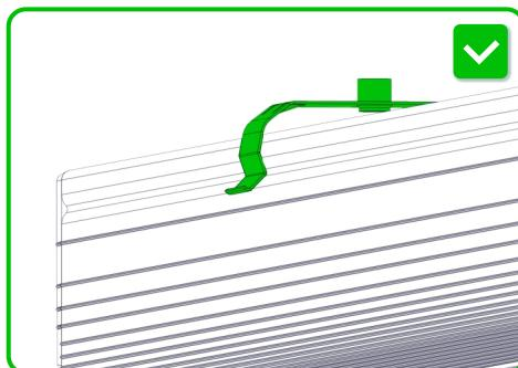
6.1 Проверьте положение пружин на светильниках. Упорные пластины на концах пружин должны быть направлены строго вверх.
