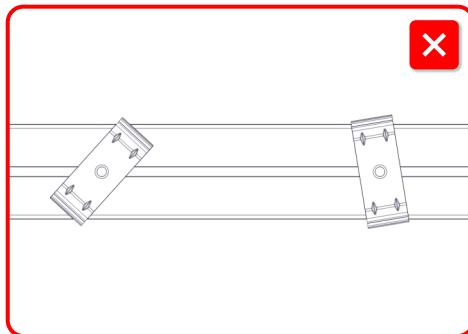
5.3 Закрепите собранные в линию светильники на клипсы. Пружинящие концы клипс должны плотно встать в боковые пазы светильников.
