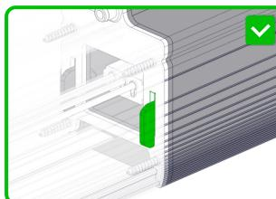
3.3 Установите комплектные винты M4x8 в верхние отверстия. Используя отвертку PH1, закрутите винты до плотного прижатия крышек друг к другу.
