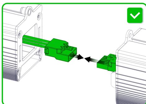
Соединители MG L, MG T и MG X
