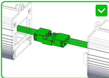
3.2 Поочередно заведите зацепы торцевых крышек всех соединителей в пазы торцевых крышек линейных светильников по Г-образной траектории (внутрь и вниз), оставляя при этом соединенные коннекторы внутри любого из светильников. Отверстия в верхней части крышек должны совпасть.
